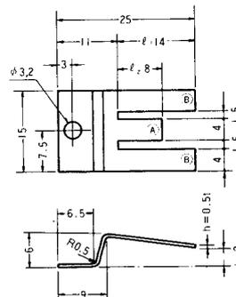
TRT14はヒートシンクに対し、トランジスタを3点で押さえることにより、放熱をより確実にします。
